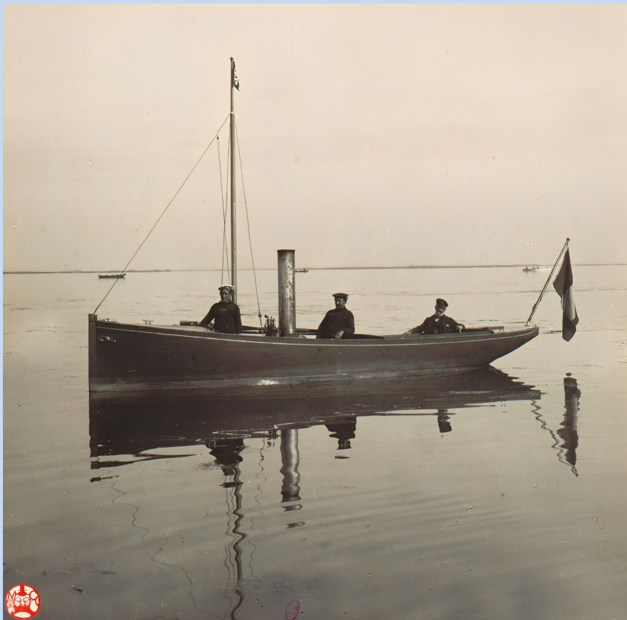
Olifan , vapeur de 3 tonneaux construit à Arcachon en 1892 pour M. de Damrémont, équipé d'une machine Castelnaud de 3 CV
